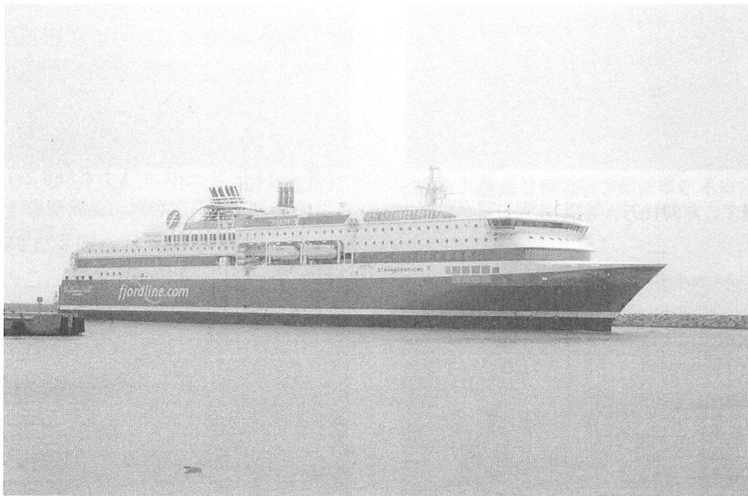
LNG燃料フェリー「スタバンガー・フィヨルド」。北欧では、新造フェリーはLNG燃料炊きにならざるを得ない。
